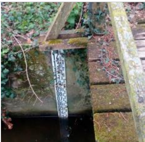
Echelle limnimétrique en aval du pont
