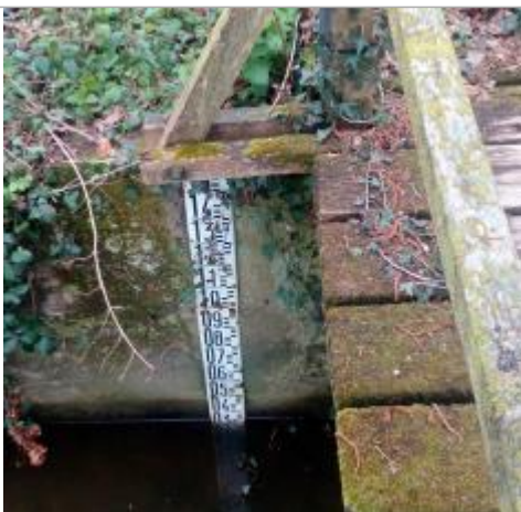
Echelle limnimétrique en aval du pont
