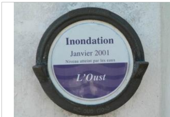
Repère normalisé de la crue de janvier 2001
