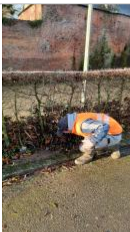
Laisse de débris de végétaux sur la haie en fer à 62 cm/sol.
