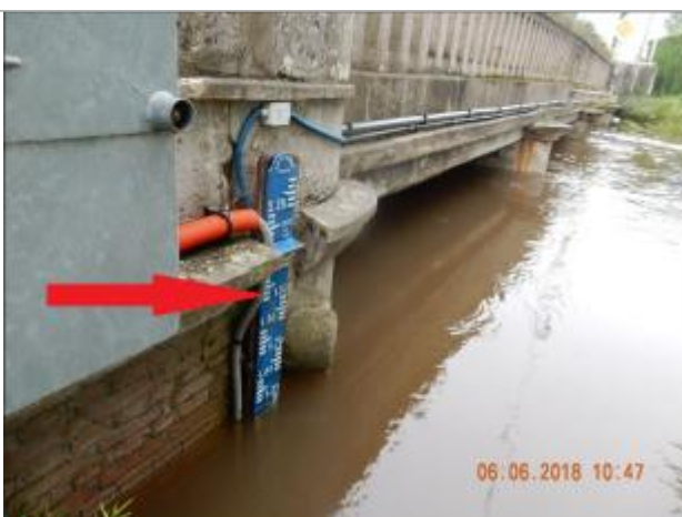
Hauteur mesurée à la station (1,923 m) au droit de l'échelle limnimétrique.
