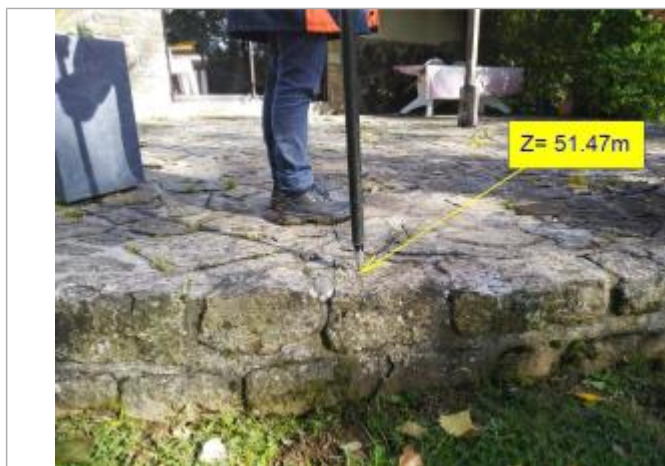
Terrasse lors du nivellement par la DDTM 22 en octobre 2021
