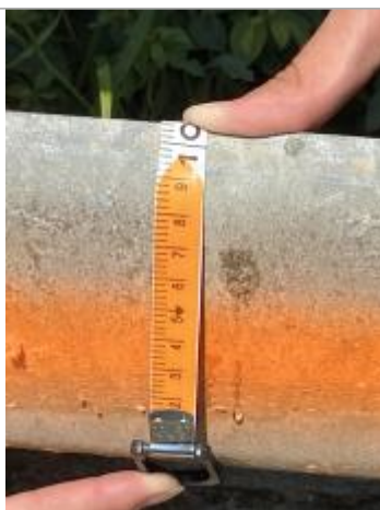
Marque de peinture sur rambarde du parc à vaches à 10,5 cm du de la glissière basse.
