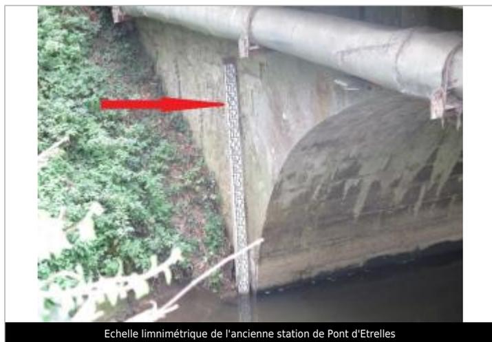
Echelle limnimétrique de l'ancienne station de Pont d'Etrelles
