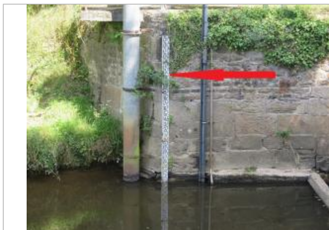
Echelle limnimétrique de la station de Saint-Jouan-de-l'Isle
