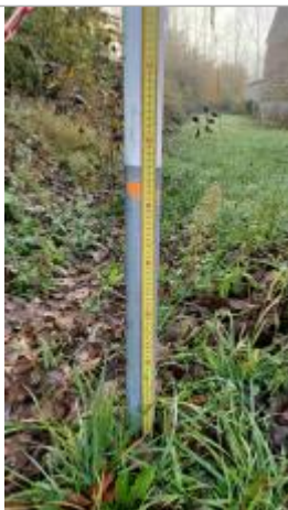
Marque de peinture sur poteau à 5,5 cm/zone supérieure blanche du poteau et à 51.50 cm du sol.
