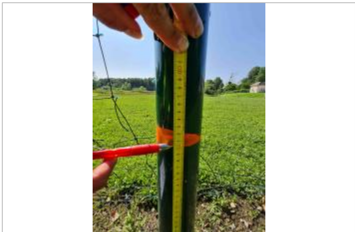
Marque de peinture sur poteau de support de filet de protection à 51.5 cm/sol.
