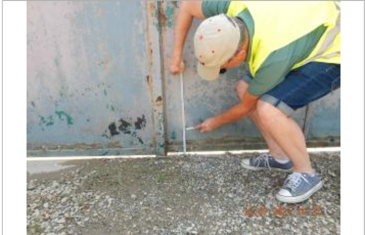
Laisse de débris végétaux sur portail métallique à 19 cm/sol
