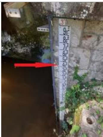
Echelle limnimétrique en aval du pont
