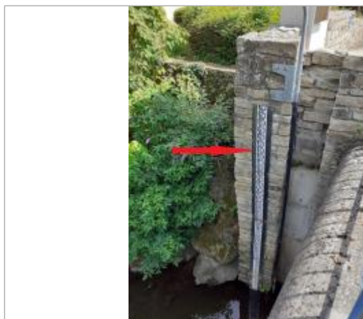
Echelle limnimétrique en amont du pont
