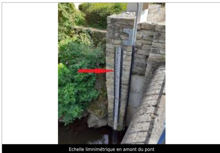
Echelle limnimétrique en amont du pont
