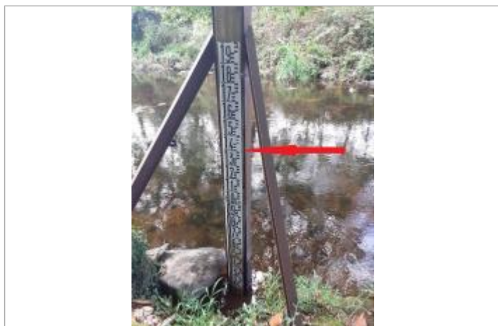
Echelle limnimétrique en aval du pont
