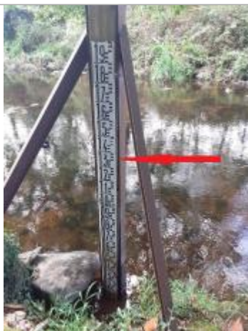
Echelle limnimétrique en aval du pont
