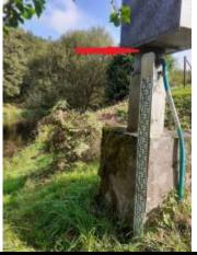
Echelle limnimétrique n°2 en amont du pont
