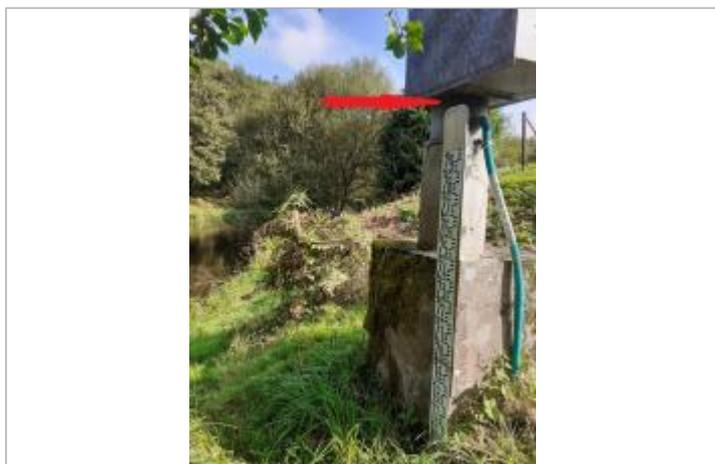
Echelle limnimétrique n°2 en amont du pont
