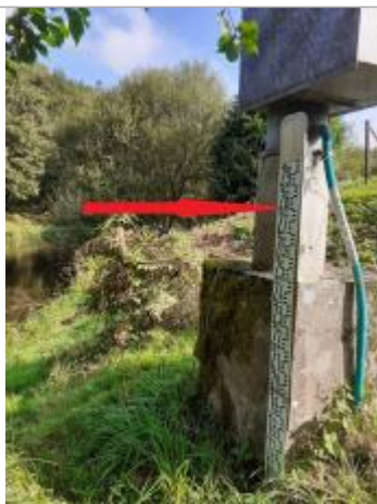
Echelle limnimétrique n°2 en amont du pont
