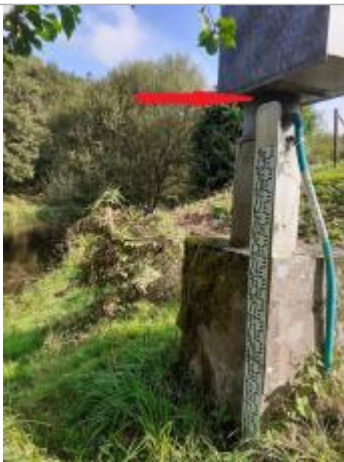
Echelle limnimétrique n°2 en amont du pont
