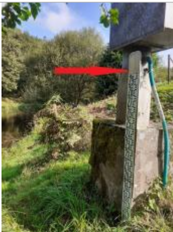
Echelle limnimétrique n°2 en amont du pont
