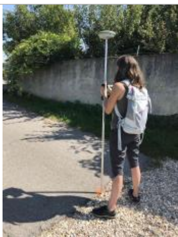
Laisse de crue au sol
