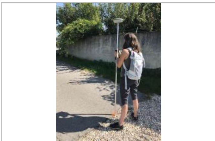
Laisse de crue au sol
