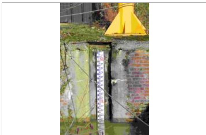
Laisse de crue visible sur niveau de l'échelle
