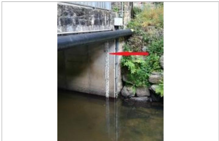
Echelle limnimétrique de l'IC à Binic
