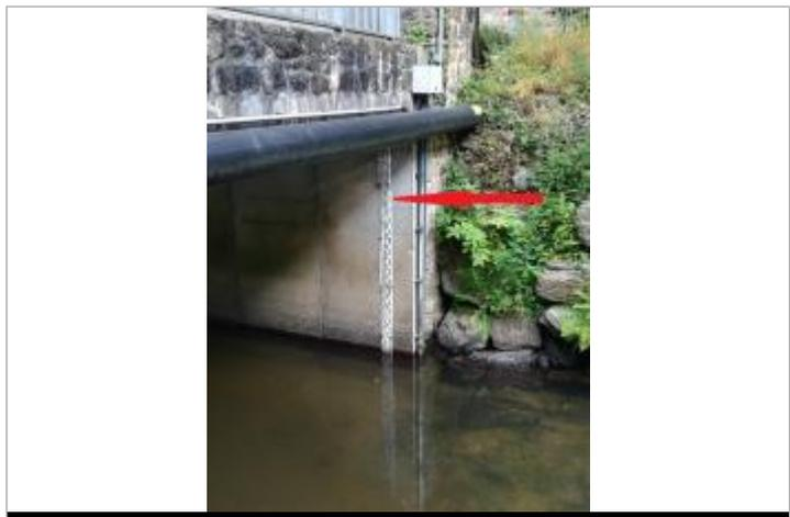
Echelle limnimétrique de l'IC à Binic
