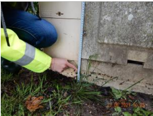
laisse de crue sur compteur électrique à 9 cm/sol
