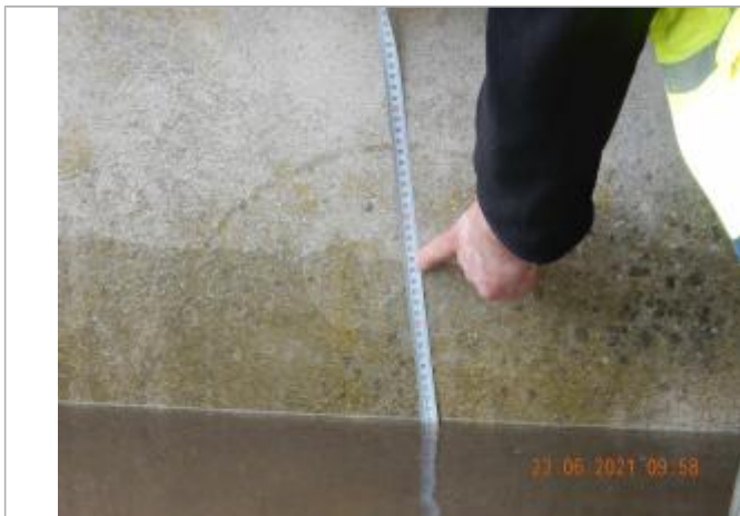
laisse de crue sur mur en béton à 26 cm/sol
