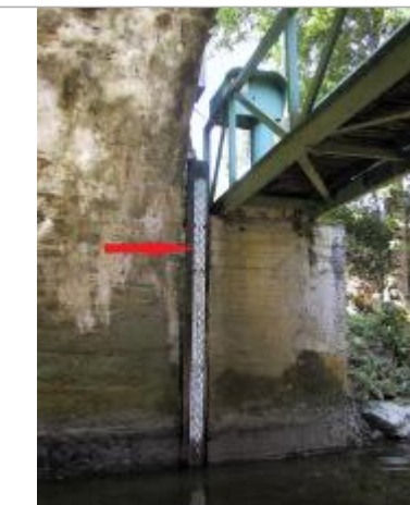
Echelle limnimétrique de la station du Lié à La Prénessaye
