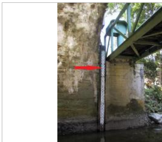
Echelle limnimétrique de la station du Lié à La Prénessaye
