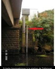
Echelle limnimétrique à la station de Trébrivan
