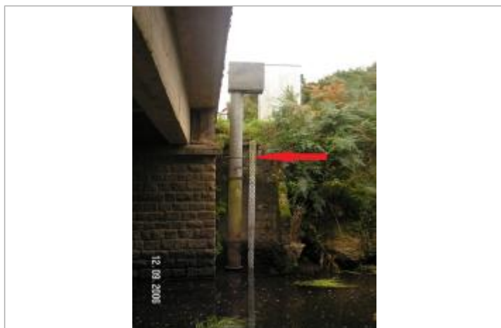
Echelle limnimétrique à la station de Trébrivan
