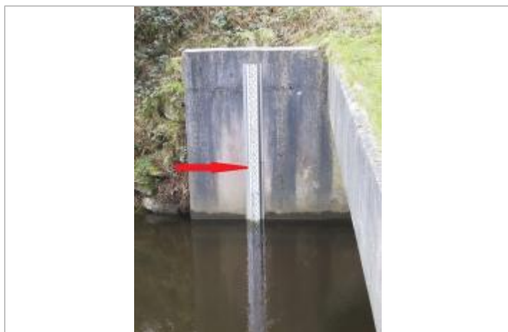
Echelle limnimétrique à la station du Blavet à Lanrivain
