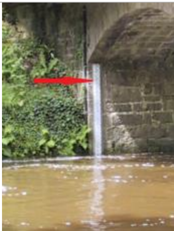
Echelle limnimétrique à la station du Léguer de Pluzunet-Le Vieux Marché
