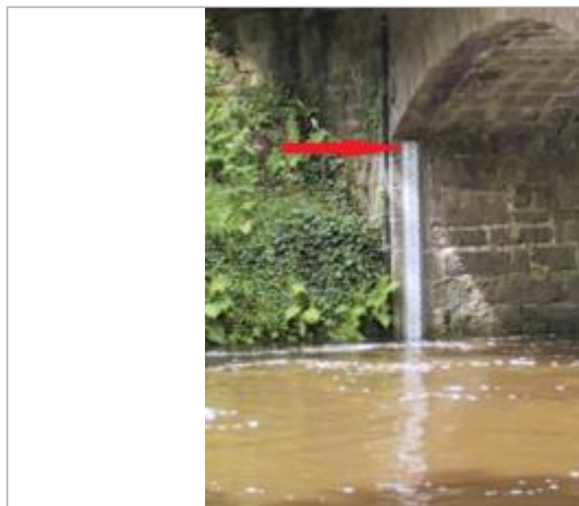
Echelle limnimétrique à la station du Léguer à Pluzunet-Le Vieux Marché
