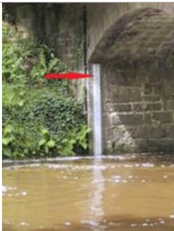
Echelle limnimétrique à la station du Léguer à Pluzunet-Le Vieux Marché
