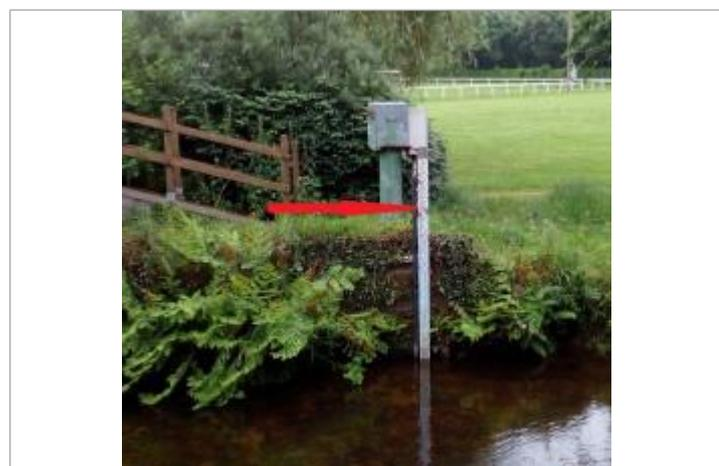
Echelle limnimétrique à la station du Léguer à Belle-isle-en-terre
