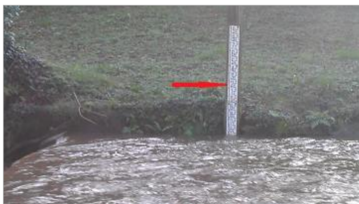
Echelle limnimétrique de la station hydrométrique de Plouguiel
