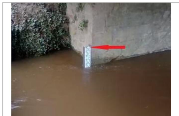
Echelle limnimétrique de la station hydrométrique de Mantallot
