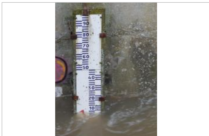
laisse de crue sur échelle limnimétrique (94 cm/sol)
