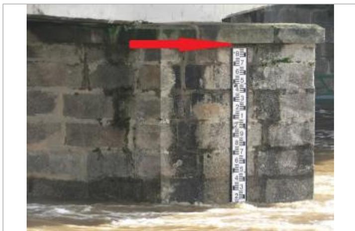
Echelle limnimétrique de la station hydrométrique lors de la crue de janvier 2008
