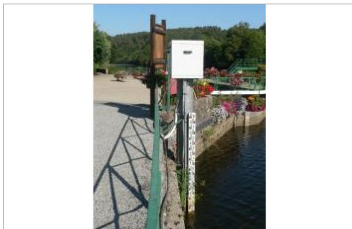
Echelle limnimétrique de la station hydrométrique
