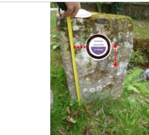
muret supportant le repère de crue
