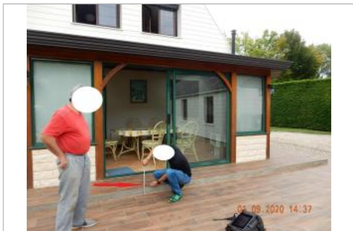
Laisse de crue 5 cm au dessus de la margelle située devant la baie vitrée de la véranda et à 17cm/terrasse
