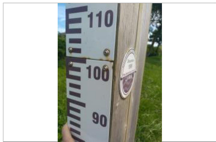
Vue sur le macaron, avec cote associée à 98 cm/sol (source : SPC SACN)
