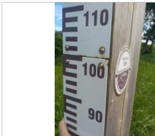
Vue sur le macaron, avec cote associée à 98 cm/sol (source : SPC SACN)
