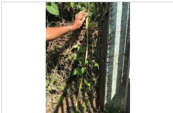
Dépôt de matière solide sur le grillage permettant de relever une PHE
