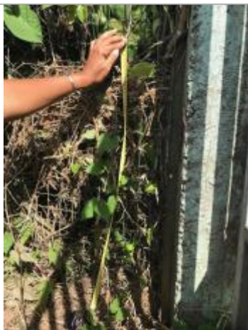
Dépôt de matière solide sur le grillage permettant de relever une PHE
