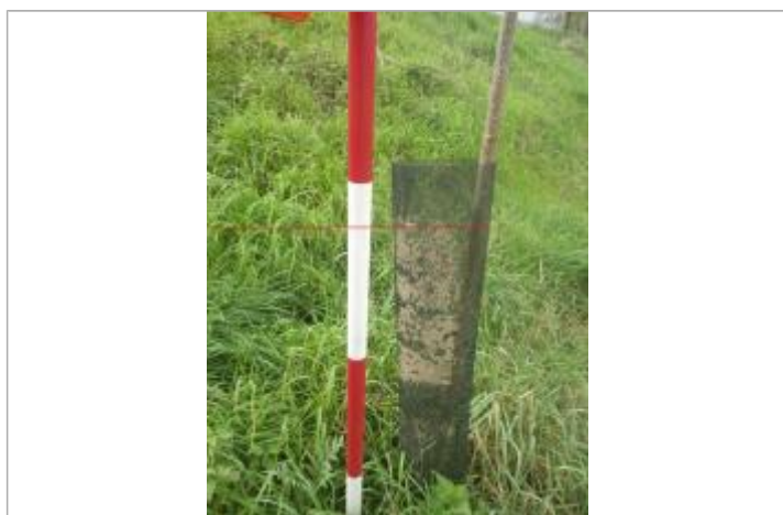
Débris végétaux grille - Photo ©AGERIN
