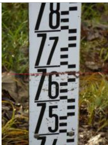
Laisse de crue sur échelle graduée - Photo ©DDT
