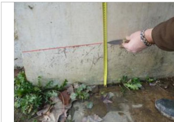
Laisse d'inondation sur le mur - Photo ©DDT
