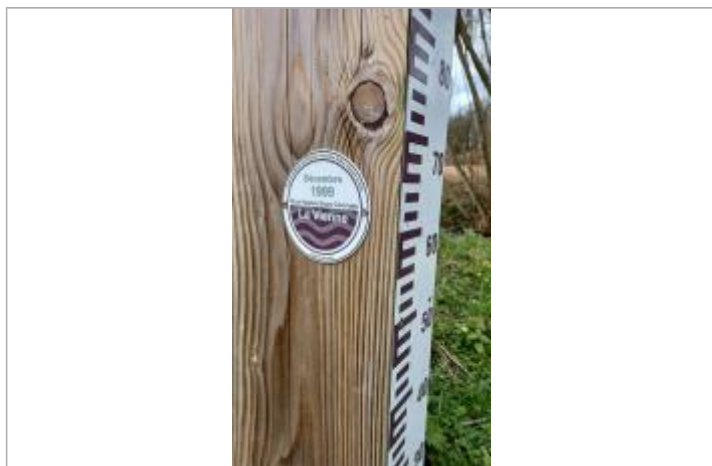
Repère sur Totem à 62 cm/échelle limnimétrique.
