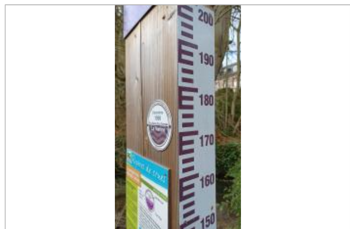
Repère sur le totem à côté du pont de la rue des Martels à 171 cm/échelle limnimétrique.
