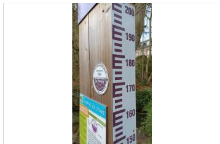
Repère sur le totem à côté du pont de la rue des Martels à 171 cm/échelle limnimétrique.
