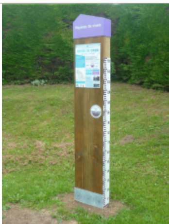
Photo du totem de repère de crue installé en décembre 2014
