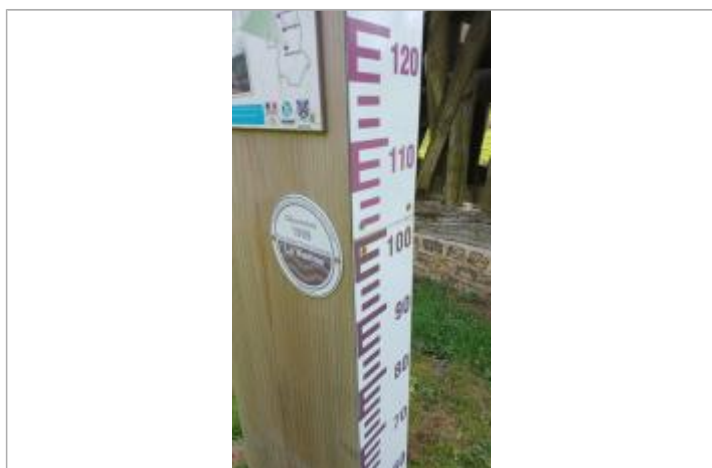
Le repère de crue est placé sur un totem situé devant le puits de la commune à 98 cm/échelle limnimétrique.
