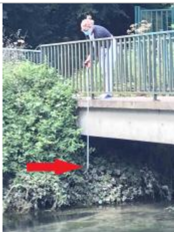
Trace de boue sur la végétation sur la berge, à 117 cm du rebord du sol (ou l'on marche) du pont
